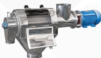
Tem a função de peneirar o produto por turbilhonamento, efetuando a separação sem atrito ou pressão. O cesto da peneira pode ser em tecido ou chapas de aço perfuradas com possibilidade de troca sem necessidade de ferramentas especiais.
