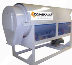
É um misturador contínuo do tipo tambor rotativo, com velocidade e inclinação regulável, com entrada das matérias - primas por uma das extremidades e saída da mistura pronta pela outra. Mistura os ingredientes sólidos dosados também de forma contínua.
