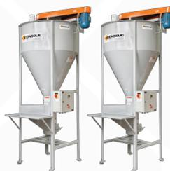
São equipamentos eficientes, robustos, práticos e econômicos tornando-se ideais para mistura de pós e granulados em diversos segmentos. Permite o ensacamento do produto misturado e garantem uma mistura homogênea em aproximadamente 12 minutos.
