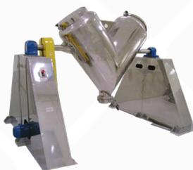
Os misturadores de tambor são equipamentos destinados a misturas por tamboreamento, onde se requer baixo nível de ação mecânica sobre o produto sem perda de eficiência na mistura. As capacidades vão de 20 a 12.000 litros.
