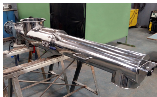
Misturador Contínuo mod. MCS-100i capacidade de 100 litros/minuto
